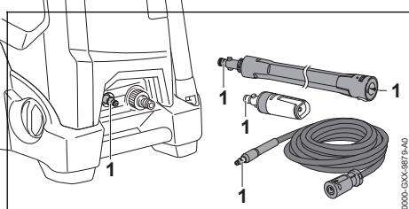
► Těsnění (1) namažte mazivem na armatury.
